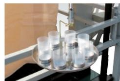
サンプルシャッターは自動で開閉しますが、カップのテーブルを適時、手動で回転させます。
